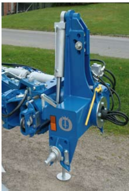
Robuuste ploegkop met snelkoppelas Cat3 en een holle wentelas van 150mm gelagerd in naaldlagers om alle krachten optimaal op te vangen.
