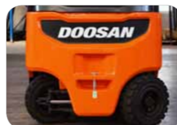
Geoptimaliseerde stuurhoek BT (3-wielshetruck): 90° BX (4-wielshetruck): 86°
