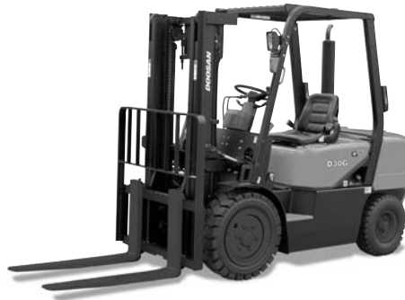
D20G / D25G / D30G 2,000kg 2,500kg 3,000kg Diesel, Pneumatic Tire
