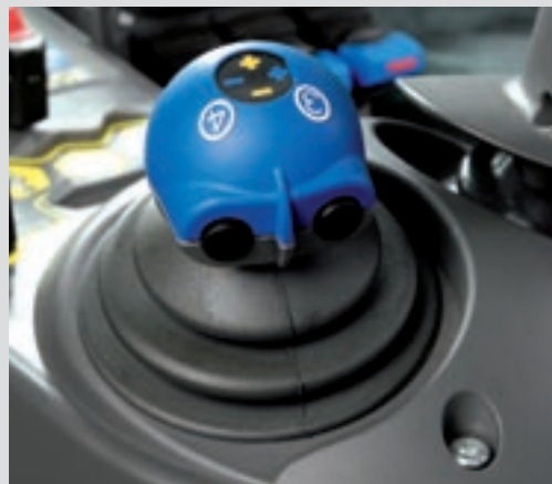
Met de kruishendel kunnen het eerste en tweede ventiel heel nauwkeurig worden bediend. Het derde en vierde hydrauliekcircuit worden met de toetsen op de kruishendel bediend.
