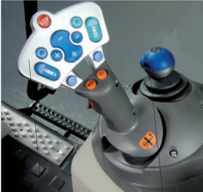
Multifunctionele joystick, met bedieningstoetsen voor achterhef, stuurventielen, derde en vierde elektrische circuit en geheugentoetsen voor cruisecontrol en motortoerental
