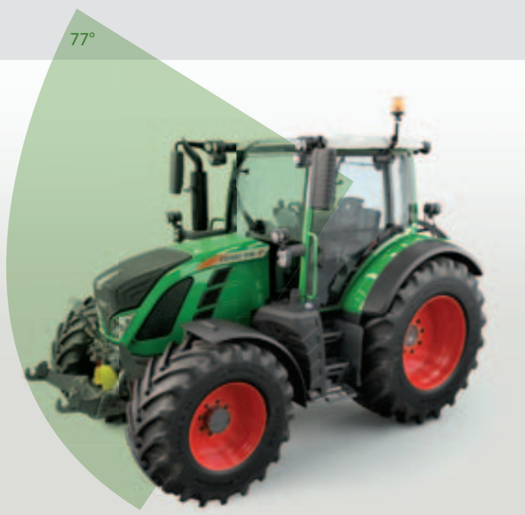
U hebt nu driemaal zoveel zicht naar boven. Ook het zicht naar beneden is verbeterd en het wielspoor is heel goed zichtbaar.
