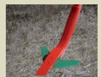
Standaard ploegpunt met vleugels van 30cm voor ondiep werken.
