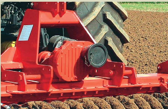
Tandwielkast met hendel. De NG-S wordt standaard geleverd met een tandwielkast met wisseltandwielen.
