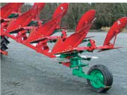
Achter gemonteerd diepte- en transportwiel Een robuust combiwiël voor de meeste ploegen. Eenvoudige verstelling van werkstand naar transportstand. De ploeg wordt in "vlinder" stand getransporteerd.*
