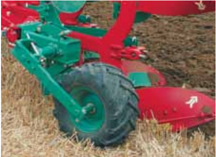
Hydraulisch diepte- en transportwiel Ontworpen voor hydraulische regeling van de ploegdiepte vanuit de cabine. Ideaal voor het ploegen van kopakkers wanneer een ondieper wordende eindbewerking nodig is.*
