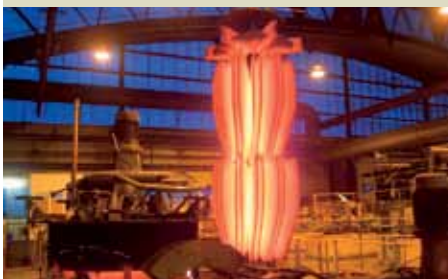
Elk raster heeft gedurende 12 uur een koolstofhittebehandeling ondergaan.
