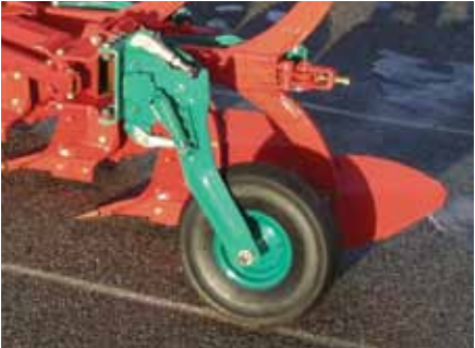
Diepte wiel Een eenvoudig diepte wiel voor kleinere modellen met rubberen wiel (6.00 x 9).
