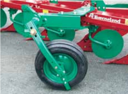
Dieptewiel, aan frame gemonteerd Dit aan het frame gemonteerde dieptewiel is leverbaar voor de meeste 4- en 5-schaar ploegen en 6-schaar LD modellen.*
