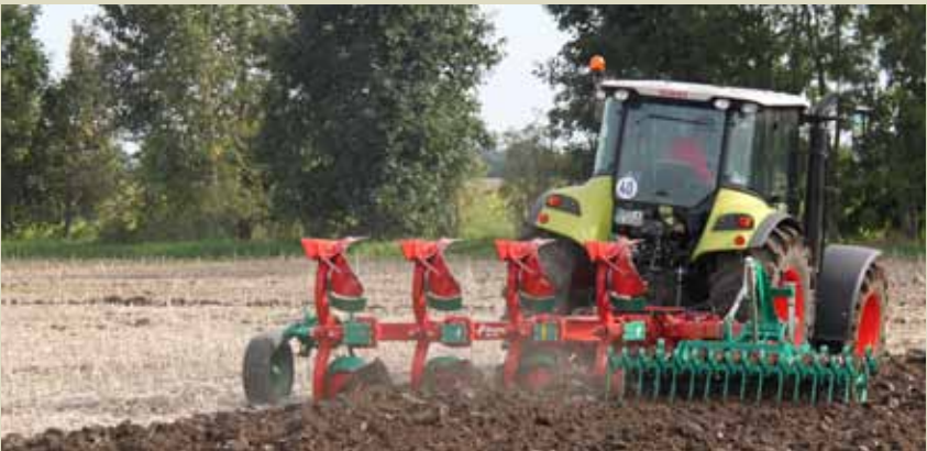
Wanneer de EM/LM ploeg wordt uitgerust met de Packomat, kan er geploegd en gepakt worden, zodat er in één werkgang een zaaibed ontstaat.
