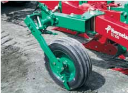
Dieptewiel met hydraulische schokdemper, achter- of framemontage Telescoop arm voor het instellen van verschillende ploegdiepten, wiel- en framehoogtes. Mogelijke dieptewielen: Rubber 320/60-12TT, 200 x 14.5, 6.00 x 9; Staal: 500 x 165.
