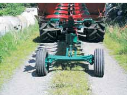
Diepte- en transportwiel, dubbel Alle brede aanbouwploegen moeten worden getransporteerd op een gecombineerd diepteen transportwiel. Dit gecombineerde diepte- en transportwiel is gemonteerd op alle 5 -, 6 - en 7-schaar EO/LO modellen. Kan ook worden gemonteerd op andere brede modellen.*
