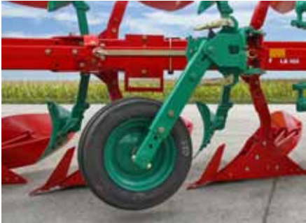
Dieptewiel met hydraulische schokdemper, achter- of framemontage Telescoop arm voor het instellen van verschillende ploegdiepten, wiel- en framehoogtes. Mogelijke dieptewielen: Rubber 320/60-12TT, 200 x 14.5, 6.00 x 9; Staal: 500 x 165.
