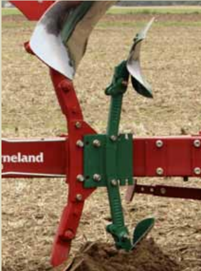
Kverneland LM is uitgevoerd met breekboutbeveiliging.
