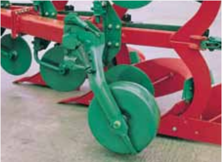
Dieptewiel Een eenvoudig dieptewiel voor kleinere modellen met stalen wiel (165 x 500).
