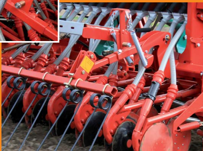
De druk van de na-eg kan eenvoudig worden versteld via een veer.
