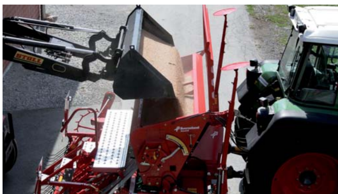
Mechanische zaadniveau meter (optioneel elektronisch leverbaar)
