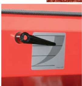
Mechanische zaadniveau meter (optioneel elektronisch leverbaar)
