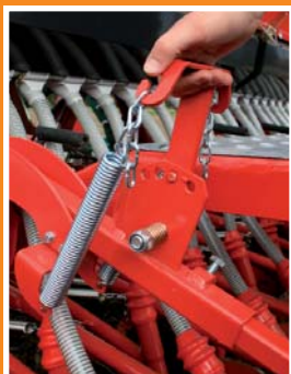
De druk van de na-eg kan eenvoudig worden versteld via een veer.
